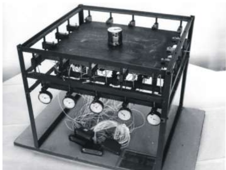
Рис.3. Управление поперечным изгибом плиты
