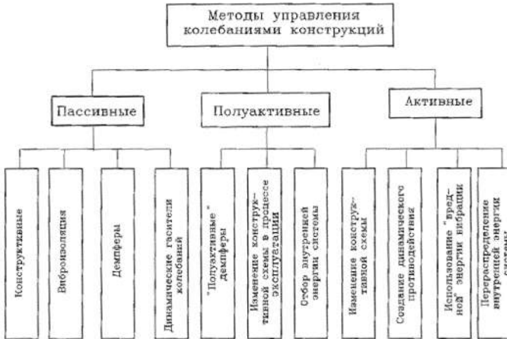
Рис.1.Методы управления колебаниями конструкций
